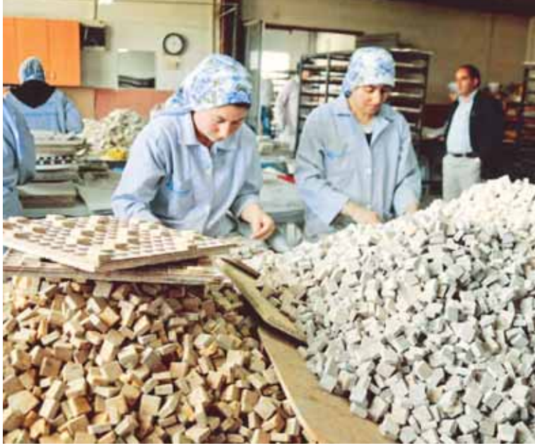
Fabrikada hurda travertenler santimlere ayrılarak mozaik karo haline getiriliyor ve talep üzerine istenen resimler bire bir uygulanmaya çalışılıyor.
